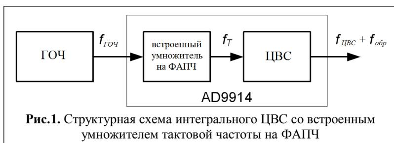
Рис.1. Структурная схема интегрального ЦВС со встроенным умножителем тактовой частоты на ФАПЧ
